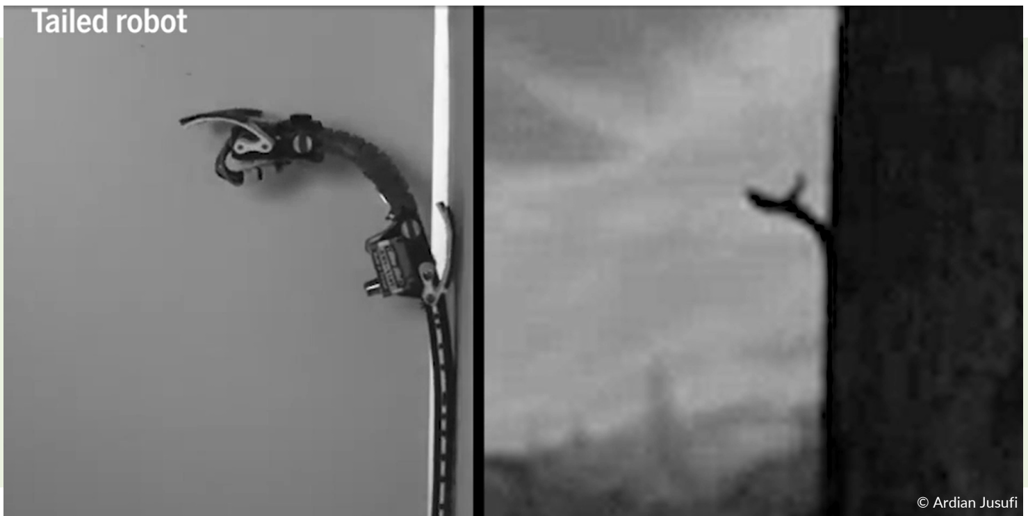
A gauche, le robot reproduisant le mouvement de Hemidactylus platyurus , un gecko de la famille des Gekkonidae (à droite).
