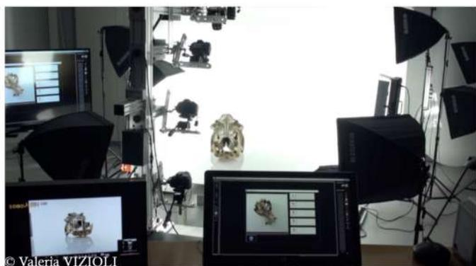
L'Université de Lille a récemment acquis un système de capture de photos 3D visant à numériser son patrimoine scientifique. Ce système permet de numériser un objet placé sur un plateau tournant à 360° à partir des images prises par cinq appareils photos pilotés par un logiciel.
